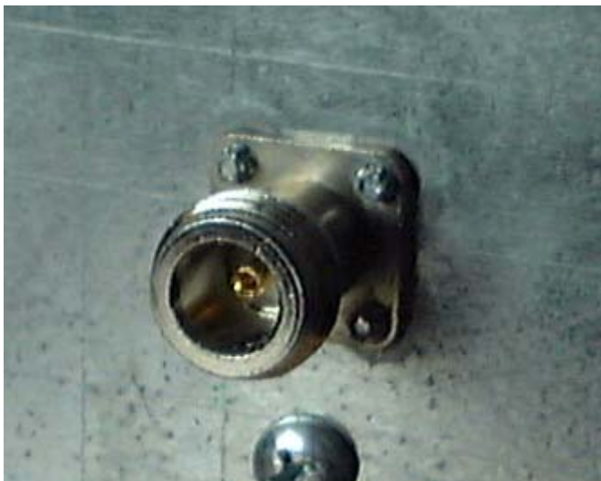
N-Type Buchse (female) an einer Antenne. Dies ist der typische Antennenanschluss für externe 2.4 GHz Antennen.
